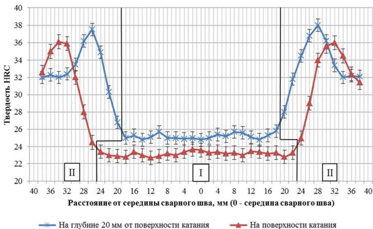
Рисунок 2- Твердость металла: I – Зона сварного шва, II – Зона термического влияния
