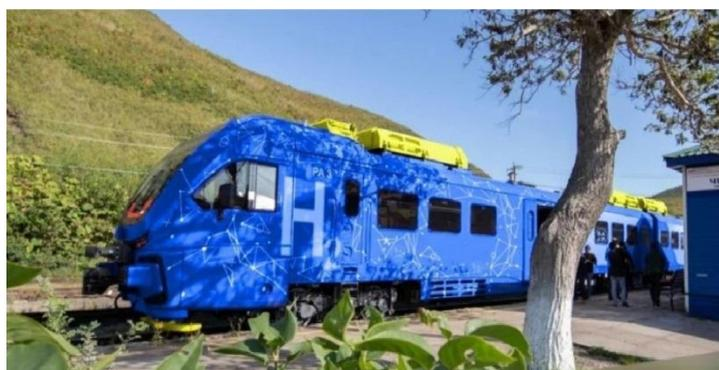
Рисунок 2 - Дизель-поезд РА3 на водородном топливе
