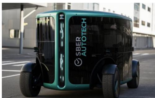
Рисунок 4 – «ФЛИП» – 6-местный полностью беспилотный электромобиль от SberAutoTech
