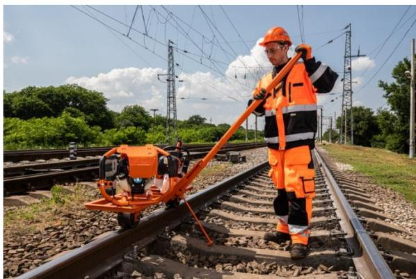
Рисунок 1 – Тележка Модерон
