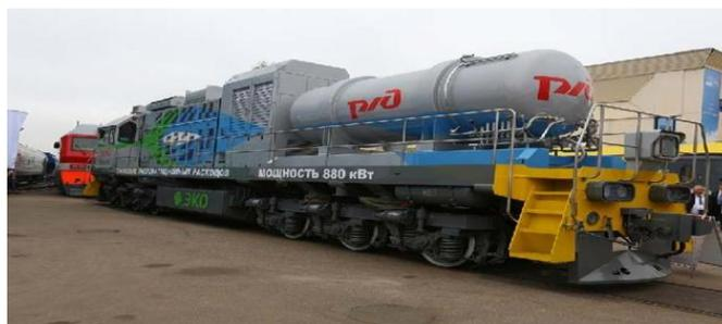
Рисунок 1 – Маневровый газопоршневой тепловоз ТЭМ19
