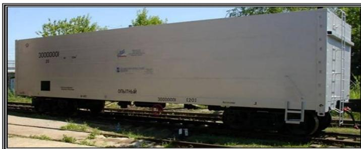
Рисунок 4 - Полувагон с кузовом из алюминиевых сплавов
