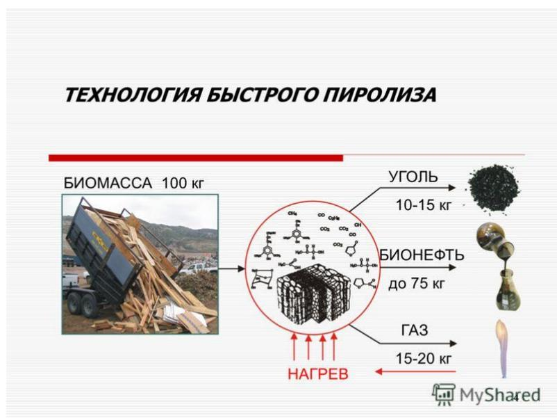
Рисунок 3 – Технология быстрого пиролиза
