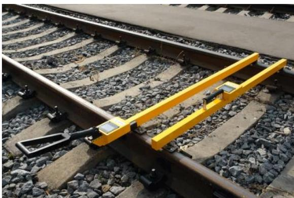
Рисунок 2 – Внешний вид шаблона АПШ-3
