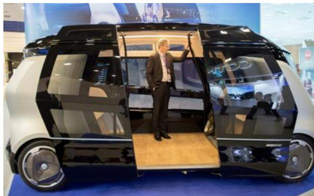
Рисунок 3 – КАМАЗ–1221 «ШАТЛ» – электробус для комфортабельной перевозки пассажиров по ограниченным маршрутам
