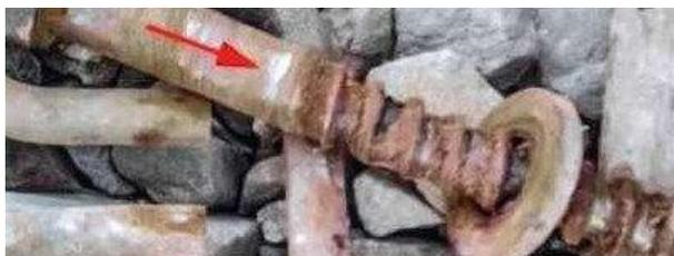
Рисунок 3 - Путевой шуруп с характерной зоной притертости (указана стрелкой)
