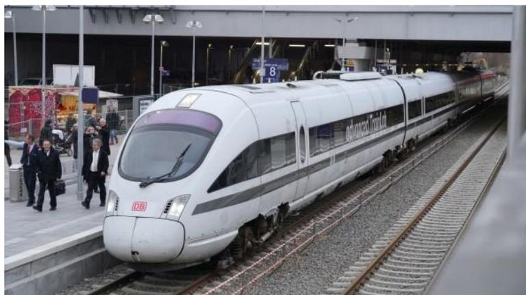
Рисунок 1 - Передвижная высокоскоростная лаборатория с дизель-электрической силовой установкой
